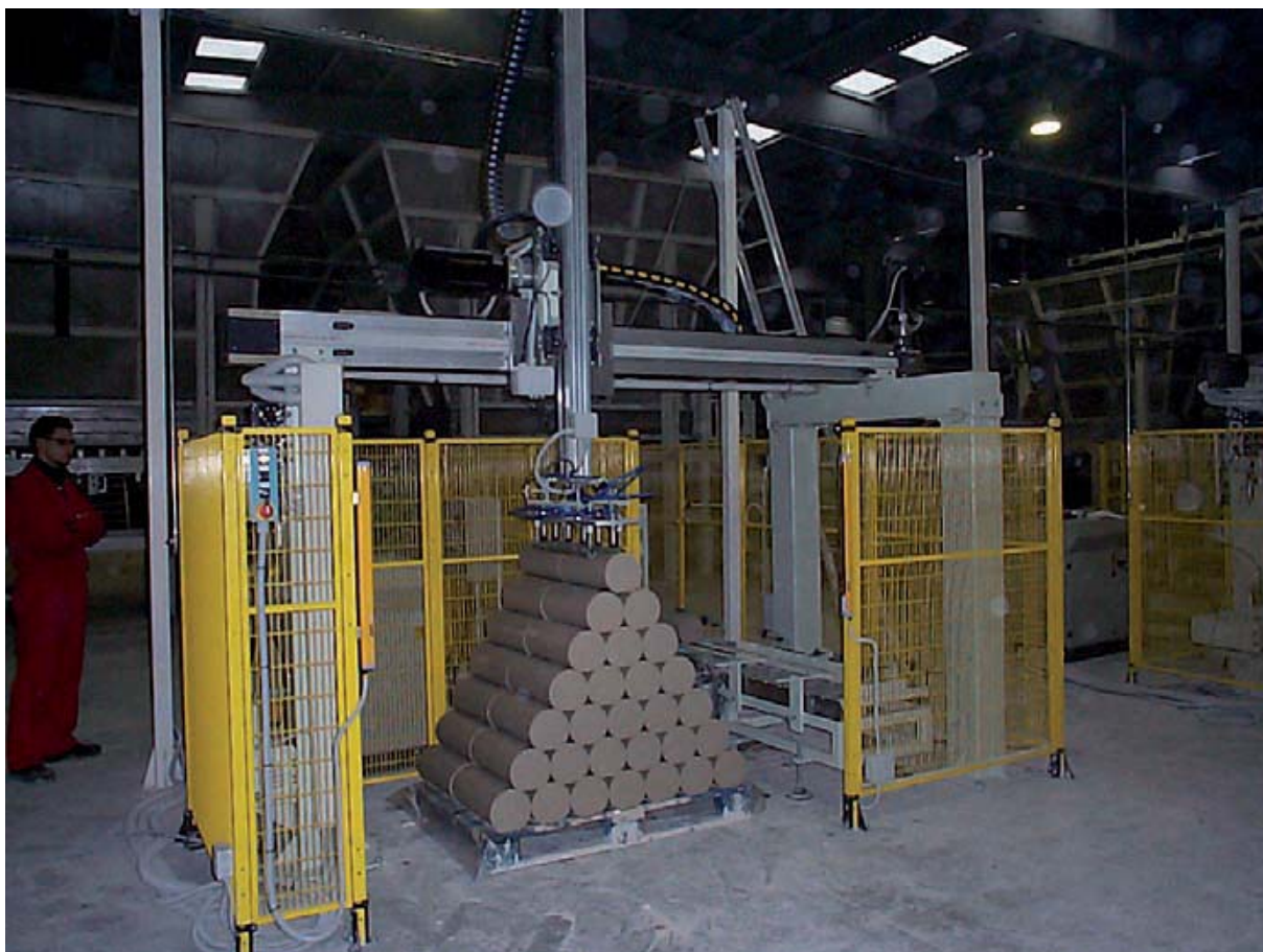
Укладчик разрезанных глиняных прутков на поддон
