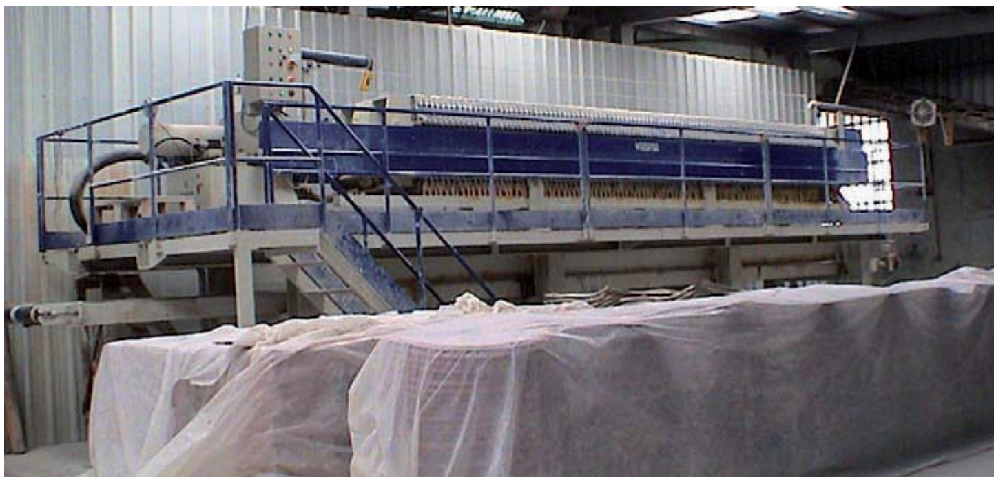
Фильтр-пресс мод. "FPP 1200-120" с разгрузочным баком
