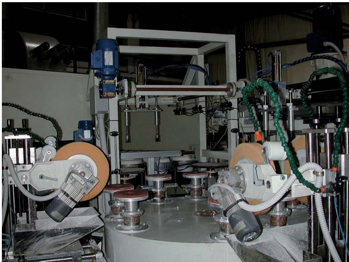
Вращающееся устройство финишной обработки мод. "FG 8"
