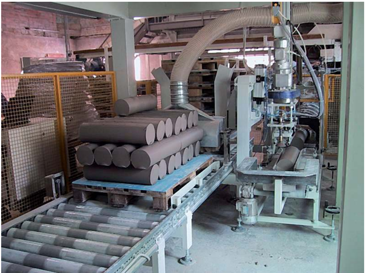
Укладчик разрезанных глиняных прутков на поддоны
