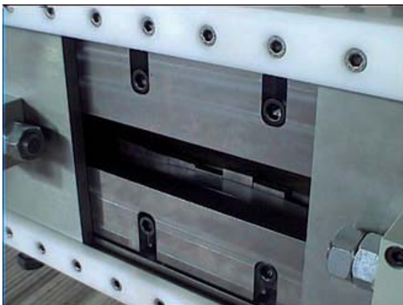
Экструзионная головка с замедлителем
